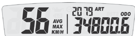
Display 3: Wechsel der Geschwindigkeit AVG/MAX, Betriebsstunde, ODO
