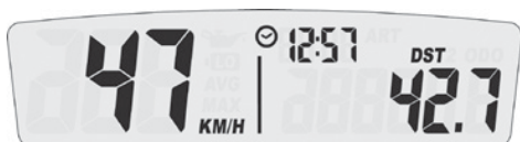
Display 1: Geschwindigkeit, Uhrzeit, DST 1
