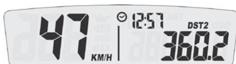
Display 2: Geschwindigkeit, Uhrzeit, DST2
